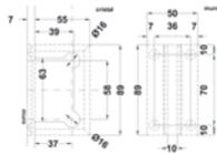
Bisagra muro-vidrio, doble acción, para 25 kg. El cristal necesita resaque para su fijación. Para puertas de cristal templado de 8 a 12 mm.
