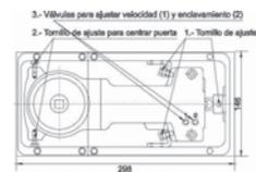
**Bisagra hidráulica para 120 kg.**
