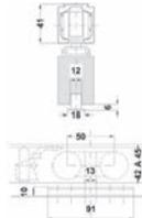
Carretilla superior con base para fijación en marco de madera o aluminio, peso máximo 90 kg por puerta.
