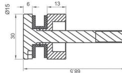
Conector con chapetón y base recta para vidrio templado de 6 a 19 mm. Carga máxima 20 kg. Incluye taquete expansivo.
