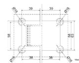
Bisagra cuadrada sin bisel vidrio-vidrio a180°, doble acción, para 25 kg. El cristal necesita resaque para su fijación. Para puertas de cristal templado de 8 a 12 mm.
