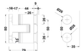
Bisagra muro vidrio peso max. 25 kg.
