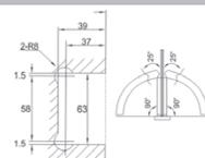
Bisagra muro - vidrio, desfasada doble acción, para 25 Kg. Para puertas de cristal templado de 8 a 12 mm.
