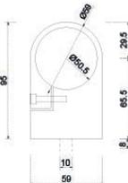
Conector de estructura metálica a barandal redondo tipo abrazadera, para tubo milimétrico.
