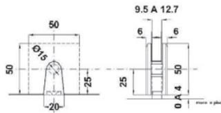
Clip biselado para vidrio fijo con resaque. Para vidrio templado de 10 a 12 mm.
