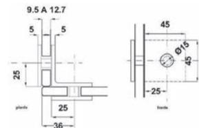
Clip vidrio-vidrio a 90°. Para vidrio templado de 10 a 12 mm. El vidrio requiere perforación.
