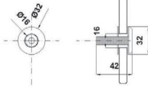
Chapetón para herrajes 1200. Útil para cambiar el avellanado por perforación a corte recto, si así se requiere. Llave para ajuste Allen.
