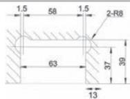
Bisagra de vibel doble acción, para 30 Kg. Fijación a piso y techo. Para puertas de cristal templado de 8 a 12 mm.
