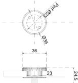
Chapetón para herrajes 1200. Útil para cambiar el avellanado por perforación a corte recto, si así se requiere. Llave para ajuste nariz de puerco.
