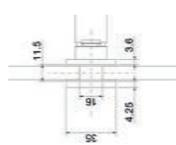
Soporte para barra cuadrada con fijación a vidrio de sistemas de puertas correzidas. Para el riel BRK3323.
