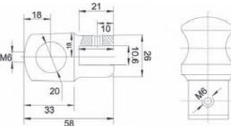
Conector Vidrio-tubo estabilizador.
