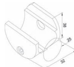
Soporte sujetador para tubo de 1" con fijación a muro.
