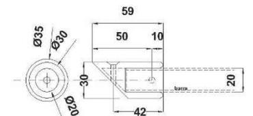
Conector para tubo estabilizador, con corte 45°. Se fija a muro con taquete.
