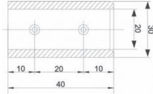
Conector para tubo estabilizador tubo a tubo.
