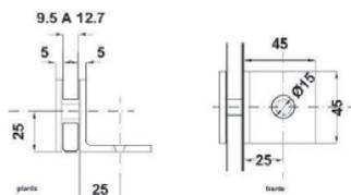
Clip para vidrio fijo a 90° se fija a muro. Para vidrio templado de 10 a 12 mm. El vidrio requiere perforación.
