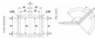
Bisagra vidrio - vidrio a 135°. Doble acción, para 25 Kg. Para puertas de cristal templado de 8 a 12 mm.
