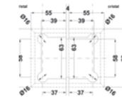
Bisagra vidrio-vidrio a180°, doble acción, para 25 kg. El cristal necesita resaque para su fijación. Para puertas de cristal templado de 8 a 12 mm.
