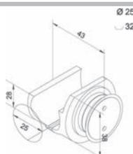
Soporte sujetador para tubo de 1" con fijación a vidrio.
