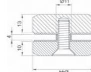
Chapetón estabilizador vidrio - vidrio. Para vidrio templado de 10 a 12 mm. No se requiere perforación.
