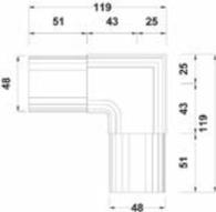
Conector tubo-tubo de 90°, para tubo de 2", esquina angular.
