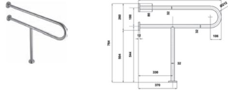
Barra estabilizadora "T+U" a 90° para lavabo 32 mm.
