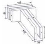
Herraje superior rectangular con portacostilla para sujetar 2 vidrios fijos a 180°
