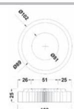
**Tapa de base redonda para poste de barandal redondo con sujeción a piso. Para tubo de 2".**
