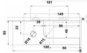
Herraje inferior con freno de cierre para puerta abatible. No requiere bisagra hidráulica para su funcionamiento.
