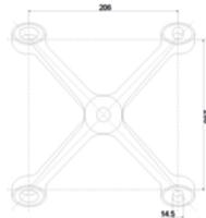
Araña de 4 patas a 90°/ Instalación a viga / Para fijación a 4 cristales.
