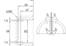
Bisagra muro - vidrio, desfasada doble acción, para 25 Kg. Para puertas de cristal templado de 8 a 12 mm.
