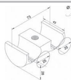
Soporte sujetador para tubo doble. Fijación a techo.
