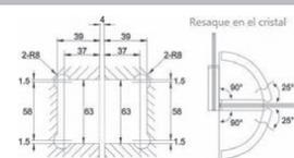
Bisagra vidrio - vidrio a 90°. Doble acción, para 25 Kg. Para puertas de cristal templado de 8 mm.
