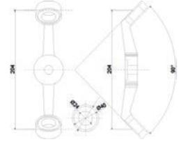
Araña de 2 patas a 90°/ Instalación a viga /Para fijación a 2 cristales
