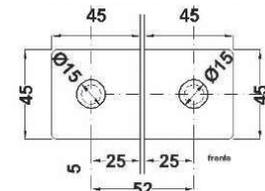
Clip vidrio-vidrio a 180°. Para vidrio templado de 10 a 12 mm. El vidrio requiere perforación.
