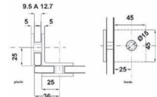
Clip vidrio-vidrio a 90°. Para vidrio templado de 10 a 12 mm. El vidrio requiere perforación.
