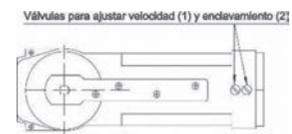
**Bisagra hidráulica aérea para 120 kg. Con pivote largo.**
