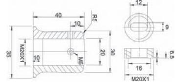
Conector para tubo estabilizador. Se fija al muro con taquete.
