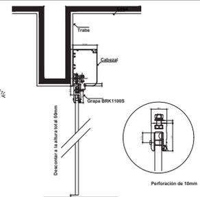
Detalle cabezal sistema automático
