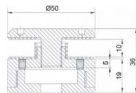
Conector con chapetón base ajustable. Para vidrio templado de 10 a 12 mm. Requiere perforación en el Vidrio. Carga máxima 50 kg.
