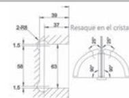
Bisagra muro - vidrio, doble acción, para 25 Kg. Fijación a muro. Para puertas de cristal templado de 8 a 12 mm.
