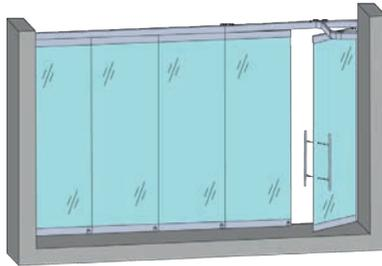
Sistema con una puerta abatible con estacionamiento de paneles perpendiculares al riel.
