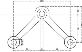
Araña de 2 patas a 45°, 20 cms a centros instalación a viga.
