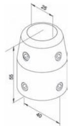
**Conector para tubo de 1" con fijación a muro.**
