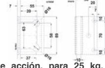
Bisagra muro-vidrio, desfasada doble acción, para 25 kg. El cristal necesita resaque para su fijación. Para puertas de cristal templado de 8 a 12 mm.
