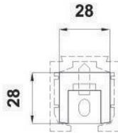
Conector interior para riel cuadrado con fijación a muro.
