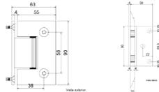
Bisagra cuadrada sin bisel muro-vidrio, desfasada doble acción, para 25 kg. El cristal necesita resaque para su fijación. Para puertas de cristal templado de 8 a 12 mm.
