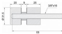
Conector con chapetón y base recta. Carga máxima 40 kg. Para vidrio templado de 10 a 19 mm.
