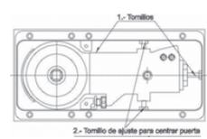
**Bisagra hidráulica para 80 kg.**
