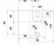
Herraje vertical superior para bisagra hidráulica, sin pivote, sujeción a pivote de giro.
