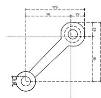
Araña de 1 pata, 20 cms a centros. Para instalación a viga.
