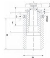
Conector soldable a estructura metálica plana o curva.
