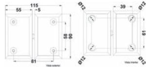
Bisagra videl doble acción, Fijación a entrepaño de vidrio. Para puertas de cristal templado de 8 a 12 mm.
