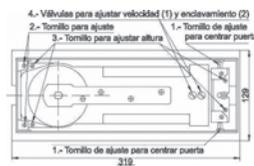
**Bisagra hidráulica para 150 kg.**
