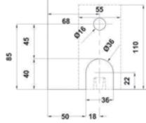
Herraje vertical inferior sin pivote, con sujeción a bisagra hidráulica, compatible con bisagra hidráulica BITEC90, BRK381 y BRK382.
