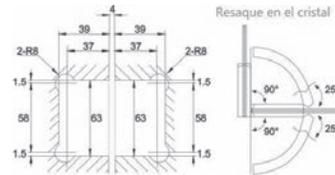
Bisagra vidrio - vidrio a 90°. Doble acción, para 25 Kg. Para puertas de cristal templado de 8 a 10 mm.
