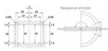
Bisagra vidrio - vidrio a 180°. Doble acción, para 25 Kg. Para puertas de cristal templado de 8 a 12 mm.
