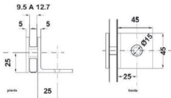
Clip para vidrio fijo a 90° a muro. Para vidrio templado de 10 a 12 mm. El vidrio requiere perforación.
