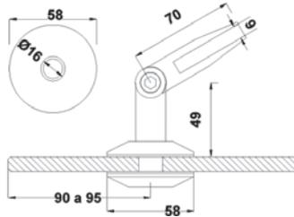
Conector vidrio-tensor para marquesina. El vidrio requiere perforación para su fijación.
