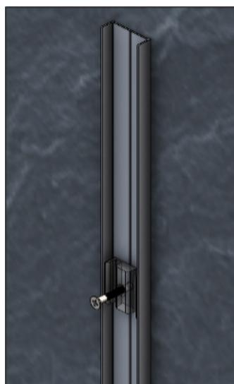
**Paso 5.-** Centrar el soporte plástico en la parte superior de la jamba y marcar las perforaciones a realizar, perforar el muro con broca para concreto de  $1/4"$ , insertar taquetes y fijar atornillando las pijas firmemente.
