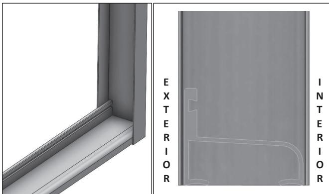
**Paso 2.-** Use un nivel de burbuja para plomear ambas jambas laterales. Marque con un lápiz ambos lados de las jambas. Realice 3 perforaciones con broca de 1/4" a lo largo del centro de las jambas, procurando que queden equidistantes, puede ayudarse con el canal guía del centro de la jamba.
