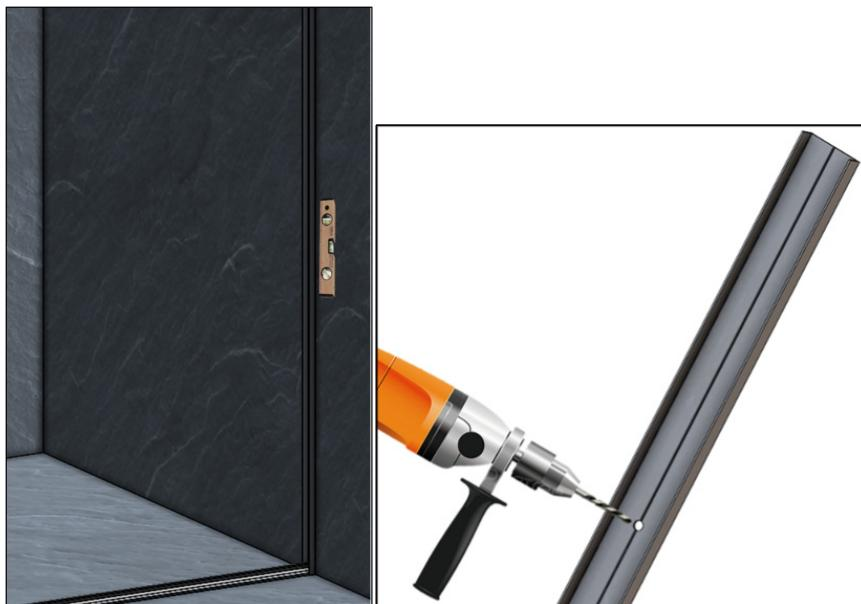
**Paso 3.-** Colocar las jambas en su posición y centralizarlas correctamente, realizar las perforaciones en el muro con broca para concreto de 1/4" conforme a perforaciones realizadas en el paso anterior, insertar taquetes en las perforaciones a muro con ayuda de un martillo.
