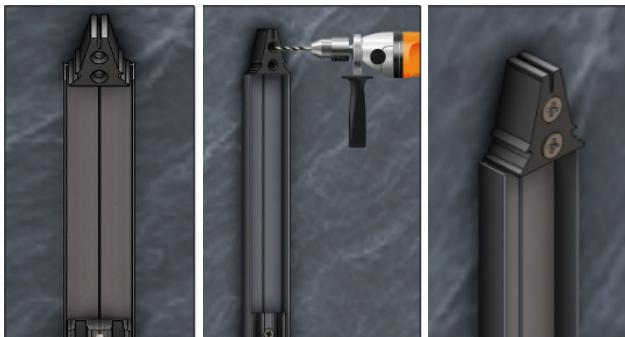
**Paso 6.-** Mida el claro en la parte superior de los soportes (de muro a muro) y corte el riel a esta dimensión menos 3mm. Coloque el riel superior en los soportes y haga presión firmemente hacia abajo desde la parte superior hasta que escuche un clic, repita en el otro extremo del riel.
